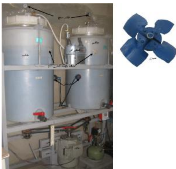
شکل ۱- دستگاه تولید بیوگاز و همزن ملخی استفاده شده با قابلیت کنترل دما، pH، دور همزن و فشار گاز تولیدی
