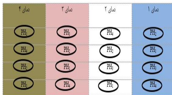
شکل ۵- آرایش واحدهای هاضم مورد نظر و نمونه‌ای از نحوه تخصیص تیمارها (در یک تکرار)
