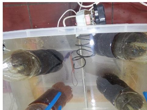
شکل ۱- نحوه قرارگیری گرمکن و ترموستات درون حمام
