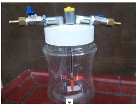
شکل ۲- الف) طرح‌واره یک واحد هاضم (۱) الکتروموتور هم‌زن، (۲) روزنه‌های تهویه الکتروموتور، (۳) شیر نمونه‌برداری مواد، (۴) سطح مواد درون مخزن، (۵) مسیر نمونه‌برداری مواد، (۶) بدنه مخزن، (۷) پروانه مورب هم‌زن، (۸) محور (شفت) متحرک هم‌زن، (۹) محور (شفت) ثابت هم‌زن، (۱۰) خروجی گاز، (۱۱) شیر نمونه‌برداری گاز، (۱۲) مخزن سامانه اندازه‌گیری (مدرج)، (۱۳) لوله خروج آب.
