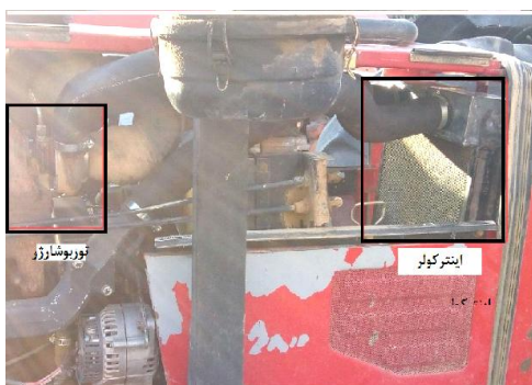
الف) محل استقرار توربوشارژر و اینترکولر
