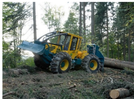
شکل ۲- تصویر اسکیدر HSM 904
